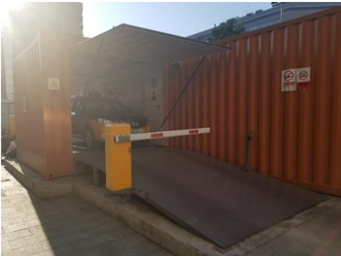
写真:北京新能源の交換対応車専用のドライブスルー形式交換ステーション。2019年9月北京で筆者撮影
